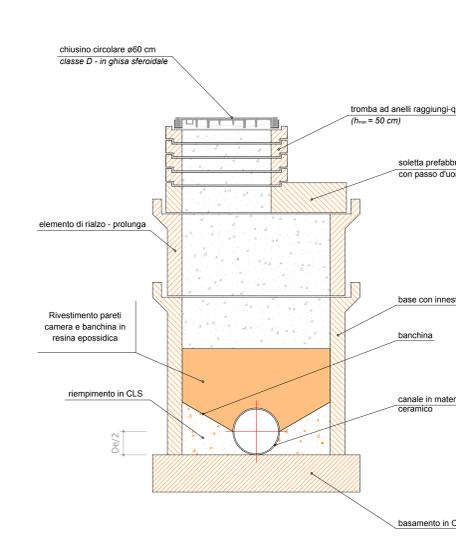
N.B.: chiusino ed elementi del pozzetto dimensionati secondo classe D norme UNI EN 124
