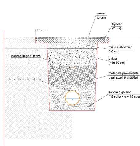
PROFONDITA' DI POSA: misurata sull'estradosso della tubazione di norma non inferiore a 0,90 m
