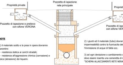
POZZETTO DI ISPEZIONE E PRELIEVO: PARTICOLARI
