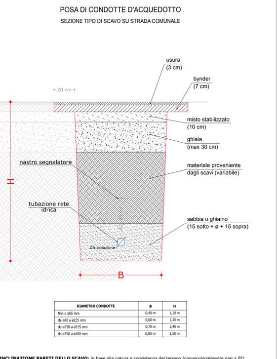
**INCLINAZIONE PARETI DELLO SCAVO:** in base alla natura e consistenza del terreno (convenzionalmente pari a 0°)
